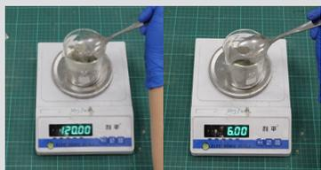
1. 根據實驗數據表一的取替比例量度所需的濾水污泥和河沙份量
