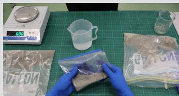
2. 把步驟一已量度好的材料和 120 克水泥倒入密封塑膠袋並搖勻
