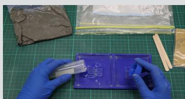
7. 倒入 1 毫升食用油於 3D 打印模具，並塗抹均勻
